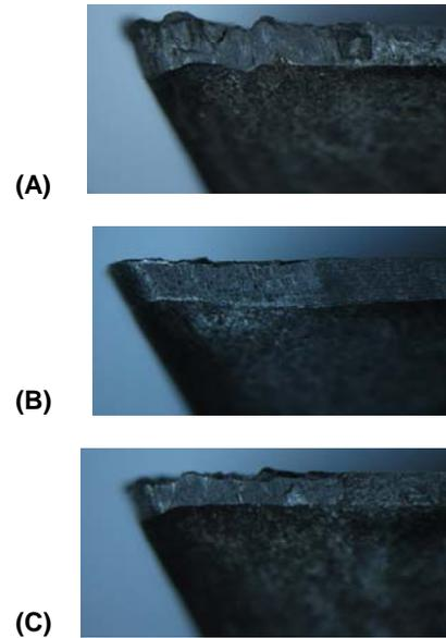
FIGURE 14 – INSERT CONDITION AT THE END OF TEST FOR: A) EXPERIMENT 1, B) EXPERIMENT 2 AND C) EXPERIMENT 3
