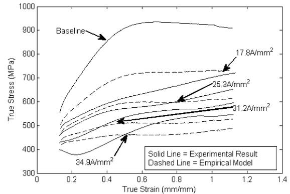
FIGURE 9. COMPARISON OF EMPIRICAL MODEL FOR 304 STEEL OVER LARGE STRAIN VALUES.
