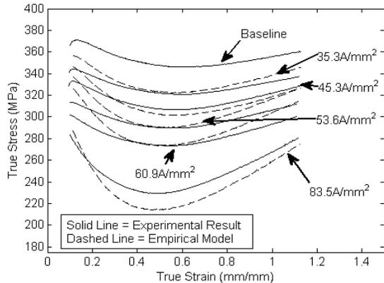
FIGURE 8. COMPARISON OF EMPIRICAL MODEL FOR COPPER OVER LARGE STRAIN VALUES.
