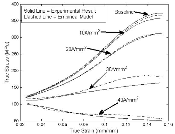
FIGURE 7. COMPARISON OF EMPIRICAL MODEL FOR MAGNESIUM OVER SMALL STRAIN VALUES.
